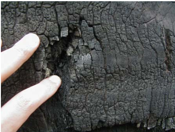
FIGURA 7.- Corteza de palma calcinada hasta 30 mm de espesor.
