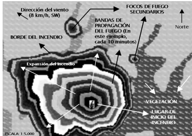
La figura muestra la aplicación de un Sistema de Información Geográfica especialmente diseñado para apoyar a la simulación y evaluación de incendios forestales
